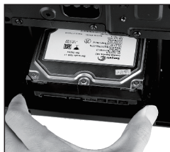
HDD konzolu vložte do násadca, vložte disk
