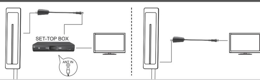
Csatlakoztassa az antennától a tápadapter bemeneti csatlakozójához vezető jelkábelét, az adapter kimenő jelcsatlakozóját csatlakoztassa a digitális jelvévőhöz, és dugja be az adaptert a konnektorba. Aztán csatlakoztassa a kábelt a digitális vevőkészüléktől a TV-készülékbe.
