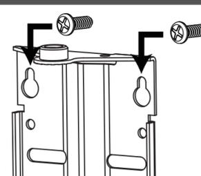
Nach der Position der Öffnungen im Halter der Antenne bohren Sie die Öffnungen in die Wand und befestigen Sie die Schrauben. Setzen Sie auf die Schrauben den Halter der Antenne und ziehen Sie sie nach.
