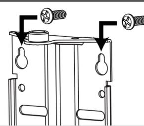
Podľa polohy otvorov v držiaku antény vyvrtajte do múru otvory a upevnite skrutky. Na skrutky nasadte držiak antény a dotiahnite.
