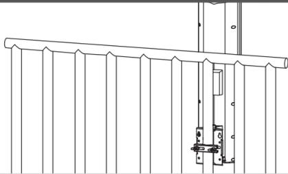
Pomocou strmeňové skrutky pripevnite držiak antény k zábradliu a utiahnite skrutky.
