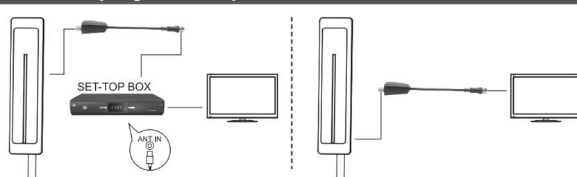
Připojte signálový kabel vedoucí od antény ke vstupnímu konektoru napájecího adaptéru, výstupní signálový konektor adaptéru připojte k přijímači digitálního signálu a zapojte adaptér do zásuvky. Poté zapojte kabel od digitálního přijímače do televizoru.
