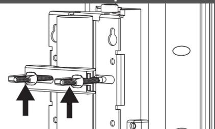
Infilare il cavallotto filettato intorno al palo, inserire il supporto dell'antenna e serrare le viti.
