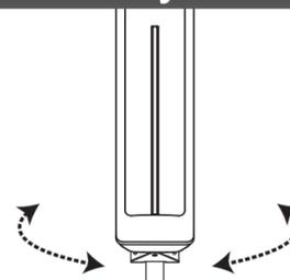
Otáčejte anténou a sledujte kvalitu obrazu, po nalezení polohy s nejlepším signálem a obrazem anténu v poloze zajistěte.
