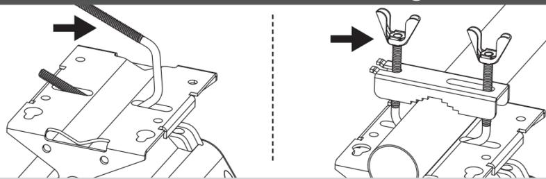
Legen Sie die Bügelschraube in die Öffnung im Halter der Antenne ein und setzen Sie darauf eine Schnalle.
