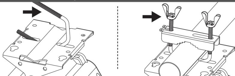
Vložte třmenový šroub do otvoru v držáku antény a nasadte na něj sponu.
