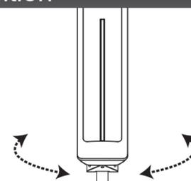
Drehen Sie mit der Antenne und verfolgen Sie die Qualität des Bildes, nach dem Finden der Position mit dem besten Signal und Bild sichern Sie die Antenne in der Position ab.
