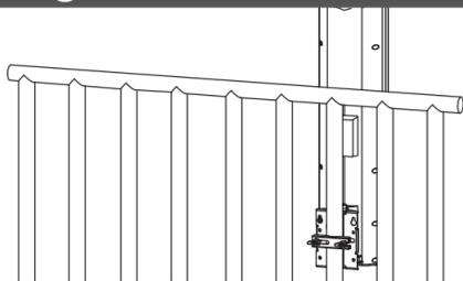
Mit Hilfe der Bügelschraube befestigen Sie den Halter der Antenne zum Geländer und ziehen Sie die Schrauben.
