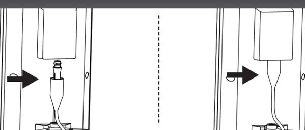
Allacciare il cavo del segnale all'uscita dell'antenna e coprire con una protezione impermeabile.
