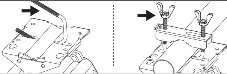
Vložte strmeňovú skrutku do otvoru v držiaku antény a nasadte na neho sponu.
