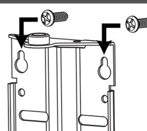
Podle polohy otvorů v držáku antény vyvrtejte do zdi otvory a upevněte šrouby. Na šrouby nasadíte držák antény a dotáhnete.
