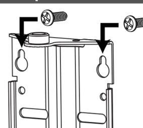
Secondo la posizione dei fori nel supporto dell'antenna trapanare i fori nel muro e fissare le viti. Posizionare il supporto dell'antenna sulle viti e serrare.
