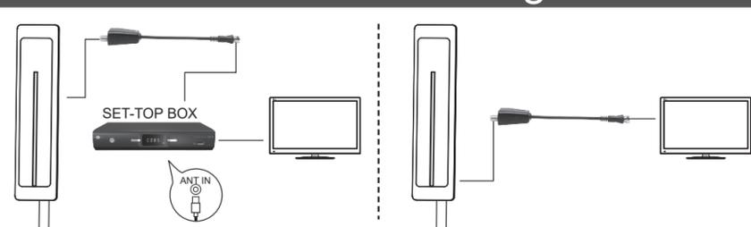
Schließen Sie das Signalkabel, das von der Antenne zum Eingangskonnektor des Speiseadapters führt, an, schließen Sie den Output-Signalkonnektor an den Empfänger des Digitalsignals an und schalten Sie den Adapter in die Steckdose ein. Danach schließen Sie das Kabel vom Digitalempfänger in den Fernseher an.
