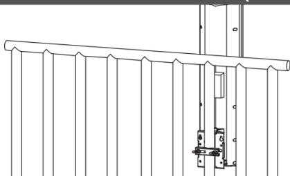
Pomocí třmenového šroubu připevníte držák antény k zábradlí a utáhnete šrouby
