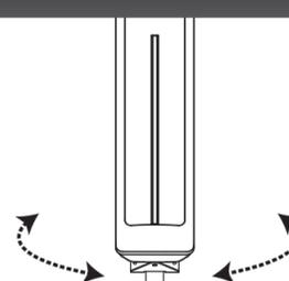
Girare l'antenna e osservare la qualità dell'immagine, dopo aver trovato la posizione con il segnale e l'immagine migliore fissare l'antenna in posizione.
