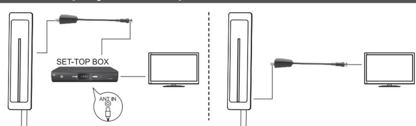
Pripojte signálový kábel vedúci od antény k vstupnému konektoru napájacieho adaptéru, výstupný signálový konektor adaptéru pripojte k prijímaču digitálneho signálu a zapojte adaptér do zásuvky. Potom zapojte kábel od digitálneho prijímača do televízoru.
