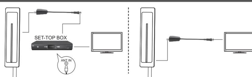
Collegare il cavo del segnale che passa dall'antenna al connettore d'ingresso dell'adattatore di alimentazione, il connettore di uscita del segnale dell'adattatore collegare al ricevitore del segnale digitale e inserire l'adattatore di alimentazione nella spina. Poi collegare il cavo dal ricevitore digitale nel televisore.
