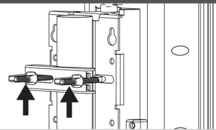
Ziehen Sie die Bügelschraube um den Mast durch, setzen Sie den Halter der Antenne auf und ziehen Sie die Schrauben.
