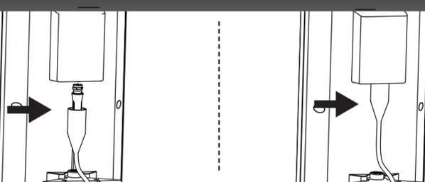
Csatlakoztassa a jelkábelét az antennakimenethez, és húzza át rajta a vízálló borítást.
