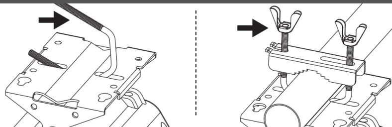
Inserire cavallotto filettato nel foro del supporto dell'antenna e inserire la graffa.
