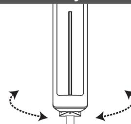
Otáčajte anténou a sledujte kvalitu obrazu, po nalezení polohy s najlepším signálom a obrazom anténu v polohe zaistite.
