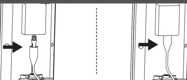
Schließen Sie das Signalkabel zum Ausgang der Antenne an und streifen Sie darüber eine wasserdichte Abdeckung.
