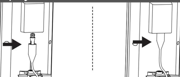
Připojte signálový kabel k anténnímu výstupu a přetáhněte přes něj vodotěsnou krytku.
