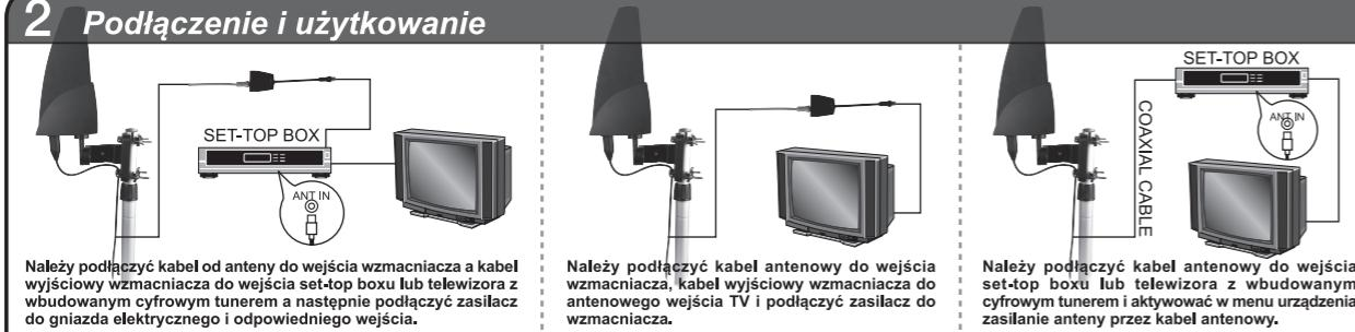
Należy podłączyć kabel od anteny do wejścia wzmacniacza a kabel wyjściowy wzmacniacza do wejścia set-top boxu lub telewizora z wbudowanym cyfrowym tunerem a następnie podłączyć zasilacz do gniazda elektrycznego i odpowiedniego wejścia.
