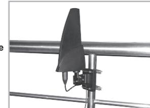
Upevněte pomocí objímek ve tvaru U držák antény k vhodnému místu balkónového zábradlí a nastavte správný úhel držáku proti otočné části antény. Našroubujte kabel zakončený F-konektorem a upevněte anténu k základně v poloze, kdy je příjem signálu nejlepší.
