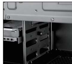
Upevněte pomocí šroubů
