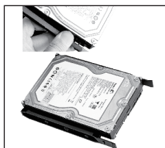
Vložte HDD konzoli do nástavce
